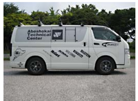
ショートタイプリヤダンパーを装着し 45mmローダウンされた開発車両
