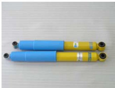
写真上 ショートタイプ 写真下 標準ストロークタイプ
